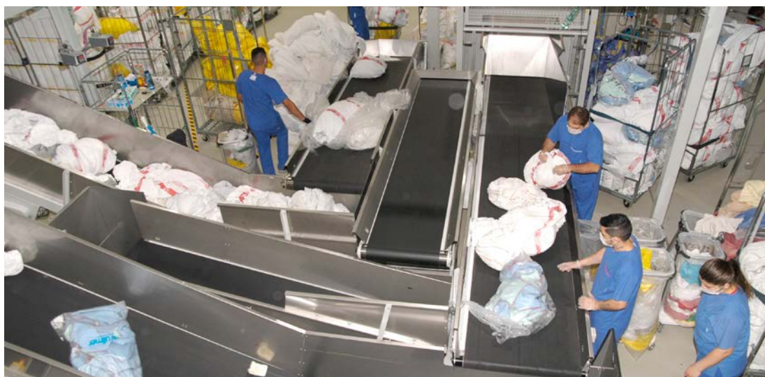
Im Wäsheeingang laden Mitarbeiter die unsortierte Wäsche auf lange Transportbänder, die sie auf den Sortierstand in sechs Meter Höhe befördern.
